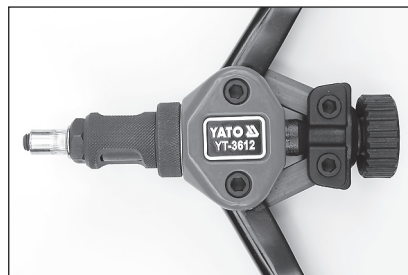
Właściwie przygotowana nitownica do montażu nitonakrętki.
