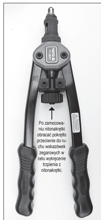
Właściwie przygotowana nitownica do montażu nitonakrętki.
